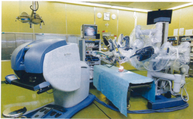
手術用ロボット「ダヴィンチ」。術者は左のボックス内でアームを操作。
